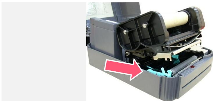
4. 前推印字頭座架釋放桿打開印字頭座架。
