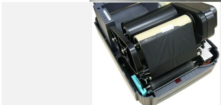
6. 以順時針方向捲動碳帶回卷軸，使碳帶前端的透明部份平整地依附在回卷軸上，直到看見黑色碳帶為止。
