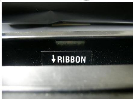
5. 拉住碳帶前端向後拉，經由印字頭座架下方 (RIBBON 貼紙處) 往前拉到碳帶回卷軸上方。將碳帶前端的透明部份平整地貼附於碳帶回卷軸上的紙軸上。
