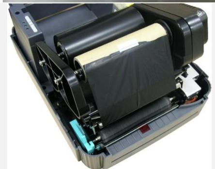
6. 以順時針方向捲動碳帶回卷軸，使碳帶前端的透明部份平整地依附在回卷軸上，直到看見黑色碳帶為止。
