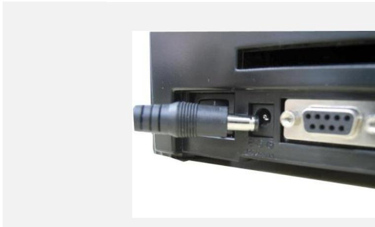
4. 將電源線的兩端接頭分別連接印表機及電源插座上。
