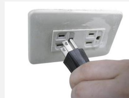
注意: 請關閉印表機的電源開關, 再將電源線插入印表機的電源插槽中。
