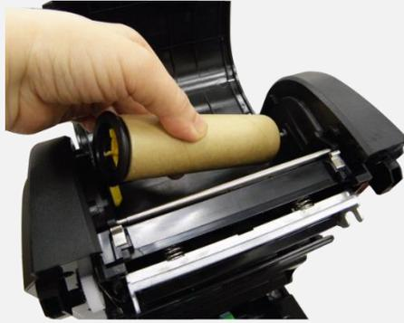
4. 先將空紙卷的右側壓入碳帶機構右側回收軸，再將左側裝入。
