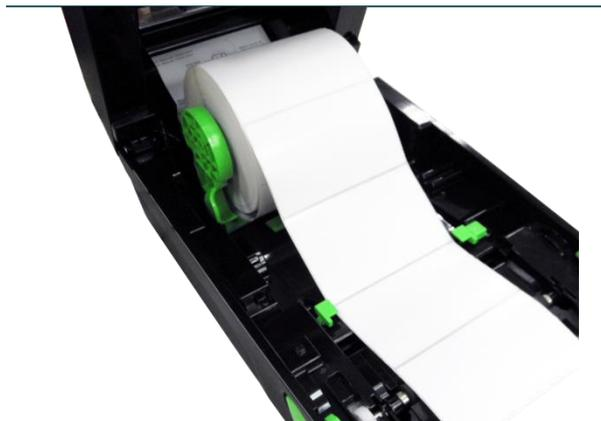
1. セクション 3.3.1 を参照し、印刷面を上向けた状態で、ペーパーをペーパーガイドを通し、プラテン上に配置します。
