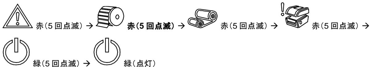
4. センサーが校正され、ラベル長が測定され、内部設定が印刷されると、ダンプモードに入ります。
