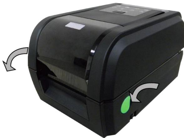
1. 両サイドにあるタブをプリンタの正面側に引いてプリンタの上部カバーを開け、上部カバーを最大開放角まで持ち上げます。
