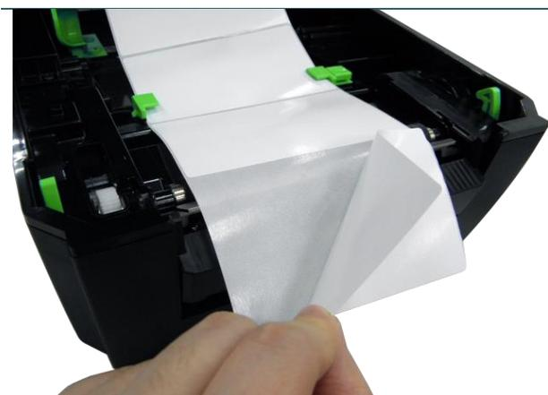
4. 上部カバーをゆっくり開きます。プリンタ正面からラベルを引き出し、ラベルをいくつか剥がしてライナーのみを残します。
