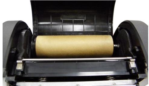
5. リボンコアにリボンサプライスピンドルを挿入します。
