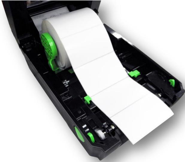
4. 印刷面を上に向けた状態でペーパーをメディアセンサーに通して置き、ラベルの先端をプラテンローラー上に配置します。
