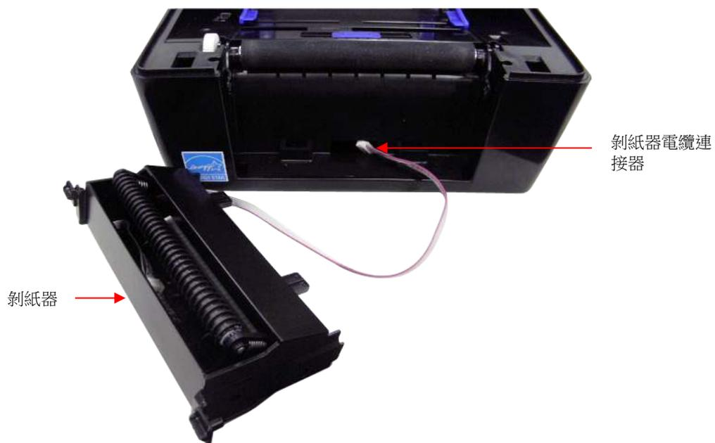
4. 將剝紙器如下圖所示，將剝紙器下方 2 個鎖定卡榫向下卡入下部內蓋。請確保剝紙器電纜已完整送入開口中沒有被剝紙器壓到。
