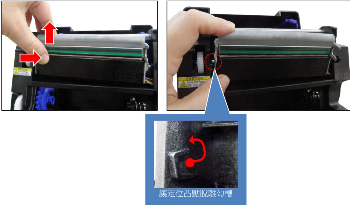
**警告** 為防止靜電損壞電子組件，請在處理和安裝印字頭之前觸摸印表機框架的未上漆部分，以便自行接地消除靜電。
