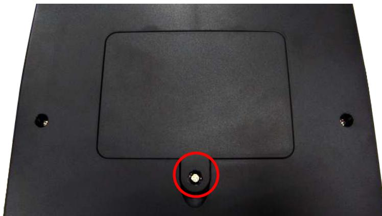
6. 將底座蓋開啟以連接剝紙器電纜至印表機主板(如下圖所示位置)。
