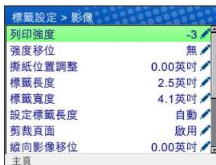
處於編輯層時，使用者可使用上下方向鍵捲動功能表及它們的值。通過按確認鍵、更改數值、並使用“應用”複用鍵確認改變數值可編輯有
