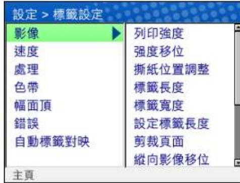
當右側子功能表顯示後，使用者可按確認鍵或右側方向鍵進入編輯層。同樣地，用戶可使用左方向鍵退回視圖層或圖示層。
