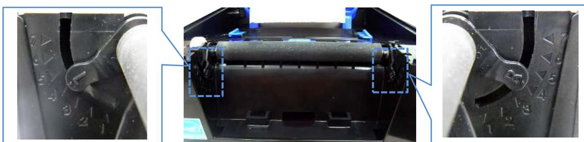
3. 根據需要調整刻錄線位置並測試列印，直到列印圖像清晰為止。
