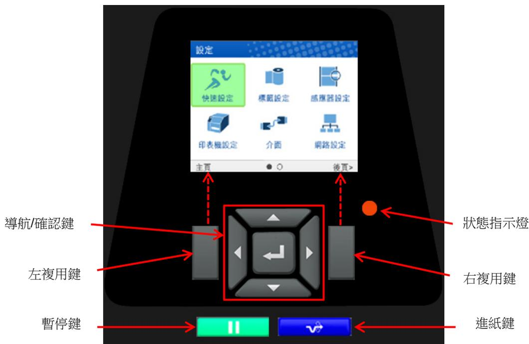
QVGA 螢幕為 320 x 240 pixel 彩色顯示器(非觸控)。螢幕上方有一頁頭會顯示印表機的狀態及使用者介面 (UI) 的位置，一般顯示區域；還包括一個頁腳，用來顯示左右複用鍵 (可用時) 的用途。
