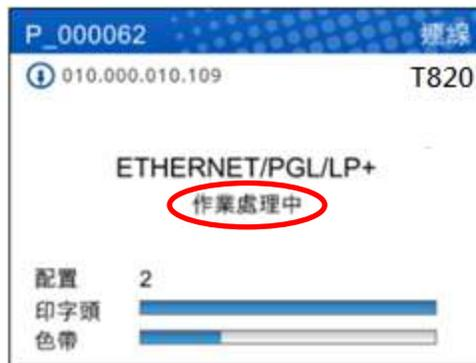
當印表機處於連線模式、正在接收和處理資料時，資訊區將顯示“作業處理中”資訊。當列印完成後，此資訊將會消失。如果使用者以批次處理方式列印且印表機設置>控制>批次處理計數器選項是被啟用時，頁面計數資料將優先於“作業在進行中”消息。
