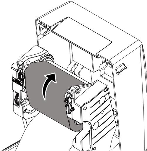
5. 依圖示箭頭方向轉動藍色回收齒輪，直到碳帶黑色區域蓋過印字頭為止並將碳帶捲緊，使碳帶上沒有任何皺摺。
