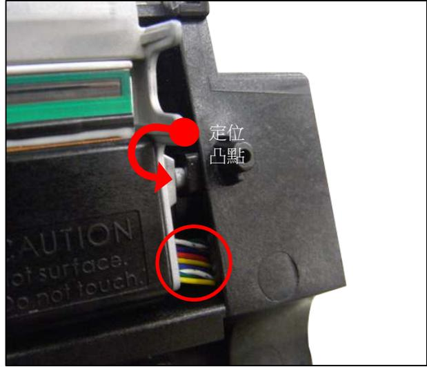
9. 之後再將印字頭模組的左側安裝入印表機，以完成更換印字頭。
