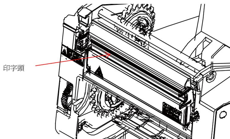
印字頭磨損最通常的現象是在列印輸出的同樣位置上以同樣的尺寸出現固定的豎直條紋。要確定豎直條紋是否由磨損的印字頭所致，可以根據下列方法：
