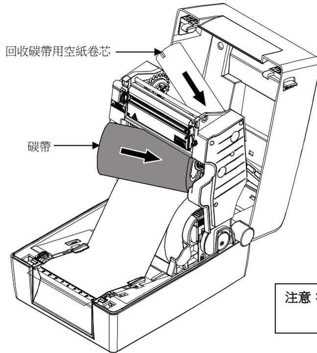
注意：請先裝(壓)入主軸右側。然後，再將左側裝入藍色齒輪左側的孔中。
