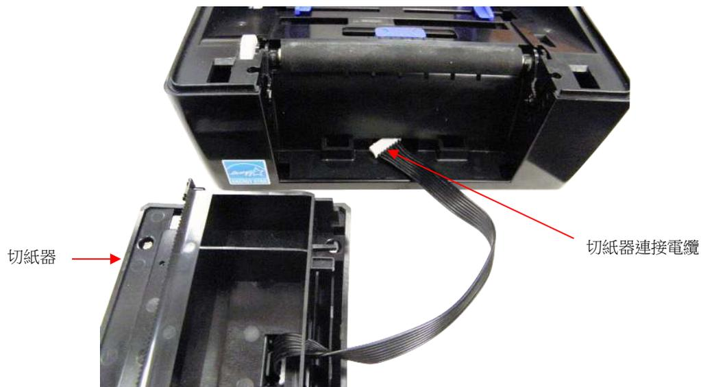
4. 將切紙器如下圖所示，將切紙器下方 2 個鎖定卡榫向下卡入下部內蓋。請確保切紙器電纜已完整送入開口中沒有被切紙器壓到。
