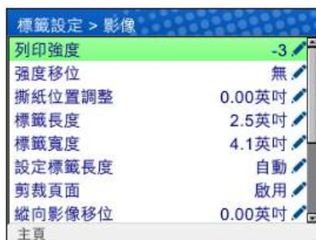
處於編輯層時，使用者可使用上下方向鍵捲動功能表及它們的值。通過按確認鍵、更改數值、並使用“應用”複用鍵確認改變數值可編輯有
