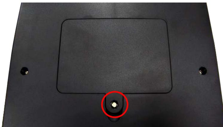
6. 將底座蓋開啟以連接切紙器電纜至印表機主板(如下圖所示位置)。
