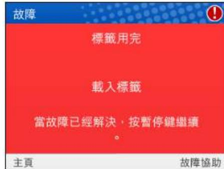
使用者可依照螢幕中顯示的簡易說明，或通過使用右複用鍵“故障協助”取得其故障的說明來排除故障。選擇故障說明時，螢幕將會顯示一套(多頁)說明來排除故障。但是，只有出現複雜故障或需要多個印表機機制步驟時才有此說明。
