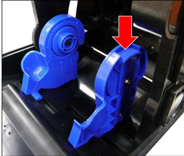
4. 將標籤紙列印面朝上，從後方進紙口拉出，經過標籤感應器並拉過橡膠滾輪。調整導紙器使其適於紙張寬度。
