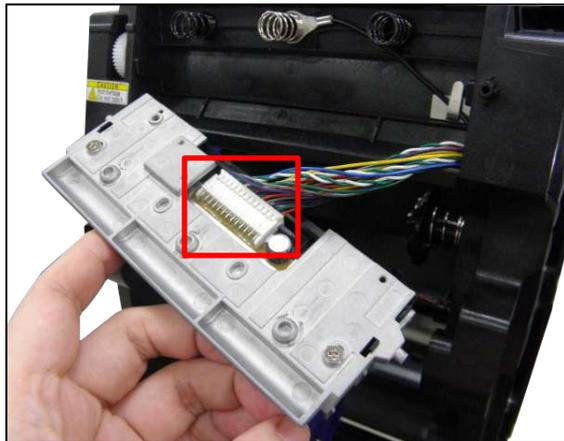
8. 為確保印字頭電纜組件為於插槽中，所以請先將印字頭模組的右側安裝入印表機，如下圖所示。
